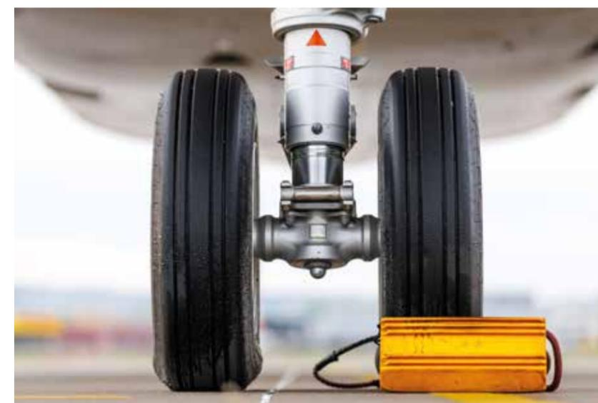
An der Parkposition werden die Bremsklötze angelegt. Die sogenannten Chocks halten die Maschine zuverlässig an der Position.
