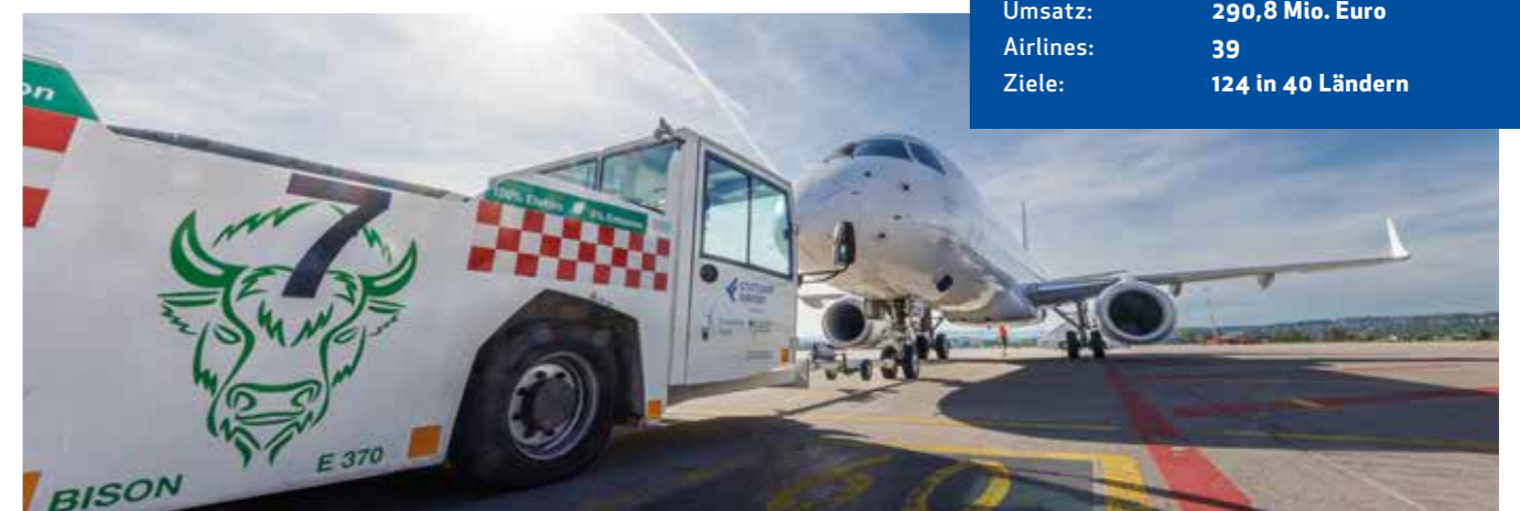
↑ Klimastrategie im operativen Alltag: E-Pushback-Fahrzeuge unterstützen als Teil der E-Flotte das Ziel eines netto-treibhausgasneutralen Flughafenbetriebs bis 2040.
