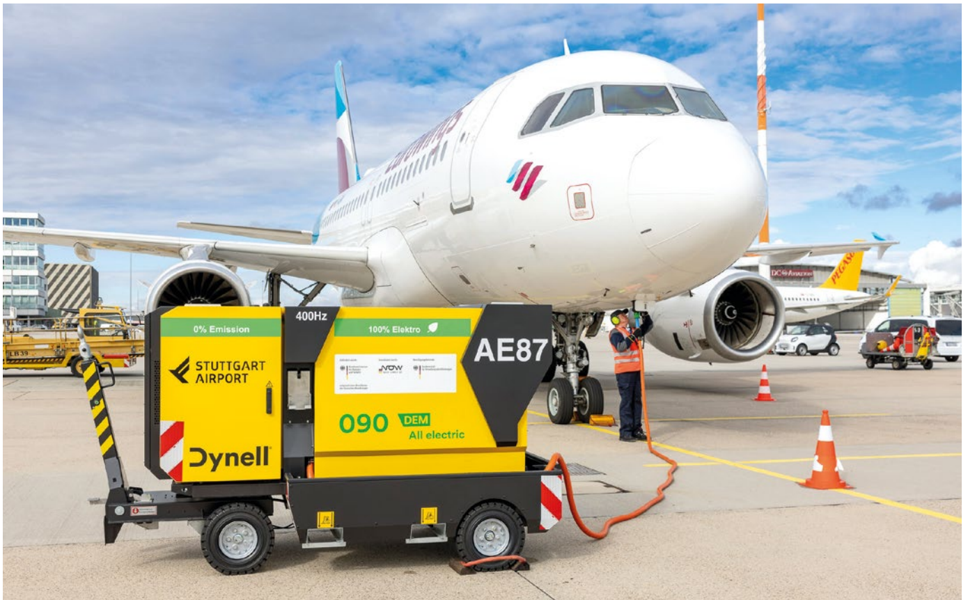
Der STR versucht, seine Emissionen wo immer möglich zu reduzieren. So bietet er den Airlines Strom aus elektrischen Ground Power Units statt aus dieselbetriebenen Geräten.
